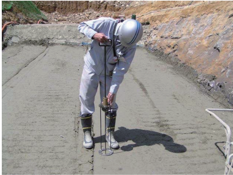
写真 8.3 球体落下試験の状況
