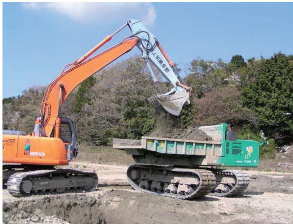
写真 7.3 バケット式解砕機
