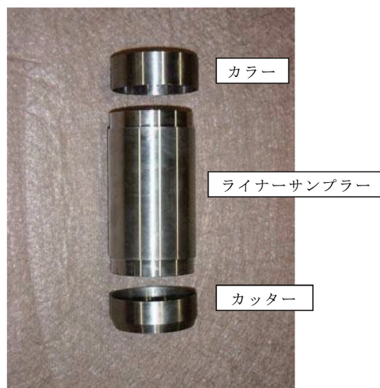
写真 8.4 ライナーサンプラー ( D/H = 75 \text{ mm} / 150 \text{ mm} )
