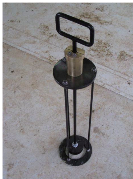
図 8.3 球体落下試験 (F w - 26 型)
