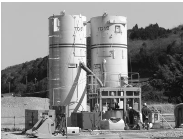
Fig.11 スラリープラントの例 Example of typical cement slurry plant facility
