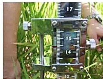
測定する際は、氷のうに逃げた水を一時的に枠内にもどしてから値を読む
