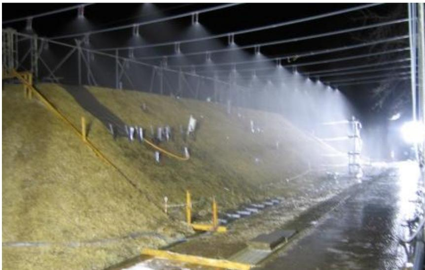
写真1 農工研の試験ため池を用いた降雨実験
