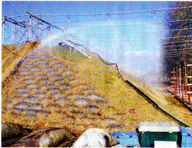
堤体表面被覆工法で改修した模擬ため池を使った降雨耐久性実験（茨城県つくば市で）
