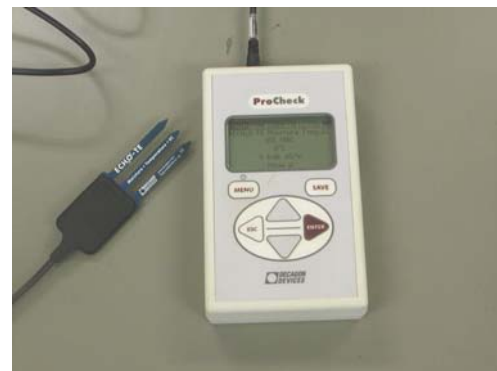
写真4 キャパシタンス法による 土壌水分計
