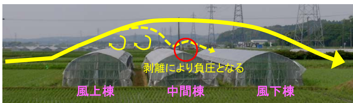
図1 パイプハウス群における気流の剥離・再付着のイメージ
