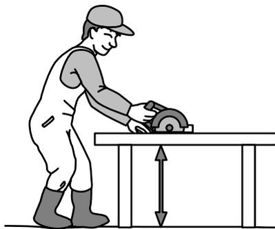
安定して作業できるように作業台や固定ジグ、足場を工夫します。
