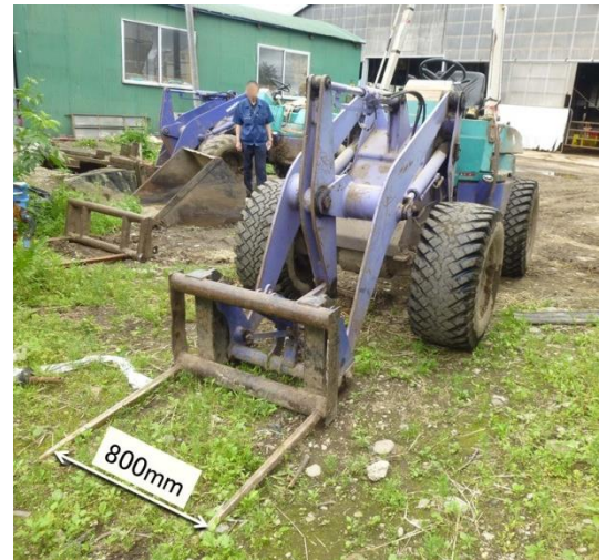
図2 ホイールローダに装着されたフォーク
