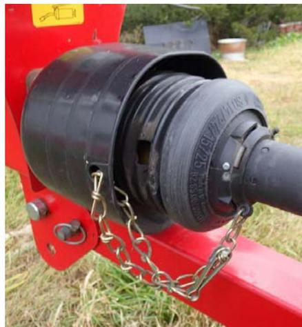
図4 適切なPIC軸ガードの例
