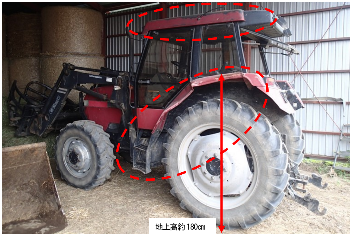
図1 トラクタ全体の外観（全幅約2.4m、全高約2.7m） （破線部が側溝逸脱時に変形、ドアは修理済。手掛りと後写鏡は事故以前から壊れていた）
