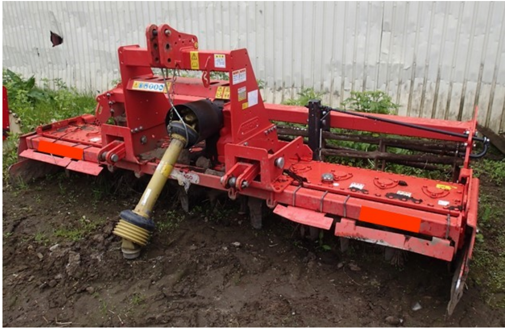
図3 事故時に装着していた作業機（パワーハロー）
