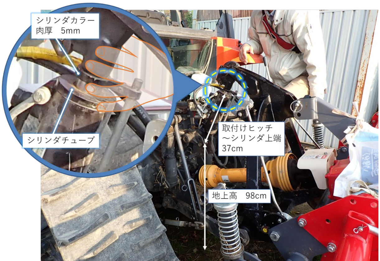
図2 油圧シリンダ周りの寸法 (吹き出し部で左手の薬指を挟まれた)
