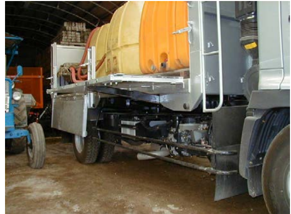
作目：共通 作業：共通 目的：効率化・省力化 方法：トラックのアオリ板を水平に支持する棒を製作。アオリ板を一時的に台として活用できる。
