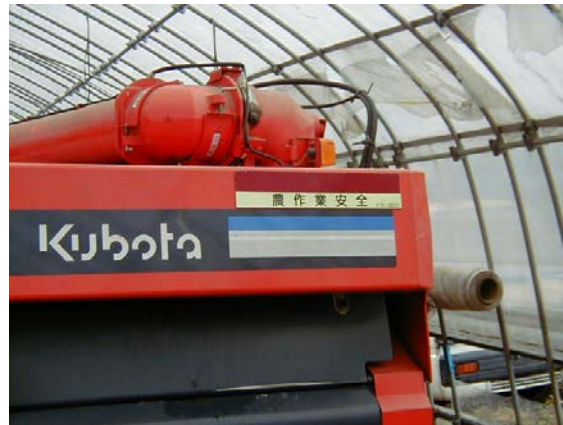
作目： 穀類、水稻 作業： 収穫、機械使用・管理 目的： 作業安全 方法： コンバインへ反射シールを貼り付け。
