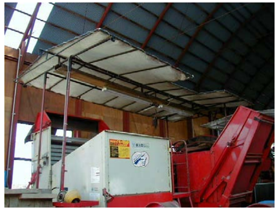
作目： 馬鈴薯 作業： 収穫 目的： 温度調節、明るさ調節 方法： ポテトハーベスタへ日よけ、蛍光灯を装備。
