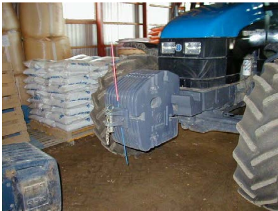
作目：共通 作業：共通 目的：作業安全 方法：トラクタの先端が分るように、目印の棒を取り付けた。
