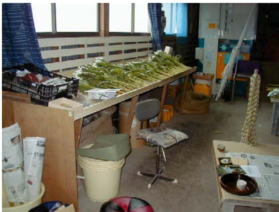
作目：花卉 作業：選別・調製 目的：作業姿勢改善 方法：見やすいように天板を傾けた作業台を設置。
