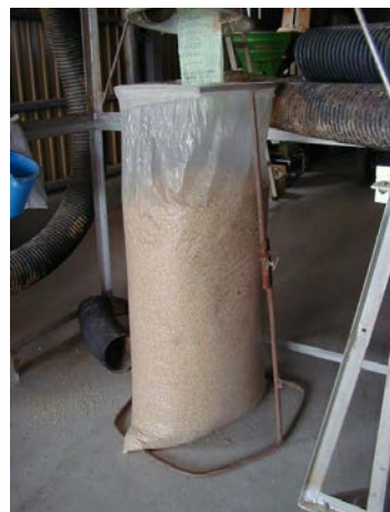
作目：穀類、水稻 作業：選別・調製 目的：効率化・省力化 方法：もみ殻袋を立てる器具を製作。
