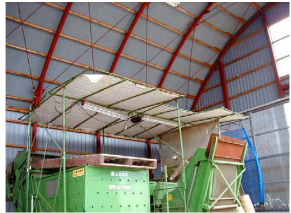
作目： 馬鈴薯 作業： 収穫 目的： 温度調節、明るさ調節 方法： ポテトハーベスタへ日よけ、蛍光灯を装備。
