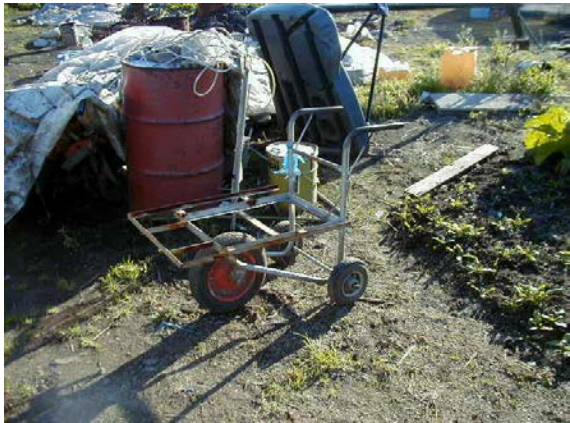
作目： 野菜 作業： 収穫、運搬 目的： 重量物負担軽減 方法： 1輪車の脚に車輪を付け3輪車を使用。平坦なところは3輪で押すだけで移動。凸凹なところは1輪で使用。
