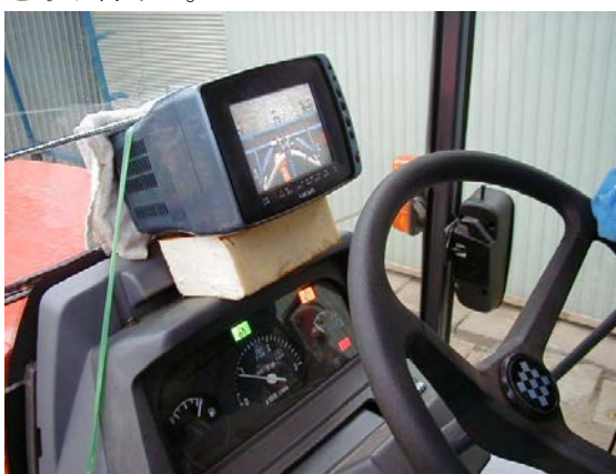
作目：共通 作業：共通 目的：作業姿勢改善 方法：キャビン後部にビデオカメラを、ハンドル付近にモニタテレビを取り付けて後方確認。振り返り動作解消し、首、腰への負担軽減。
