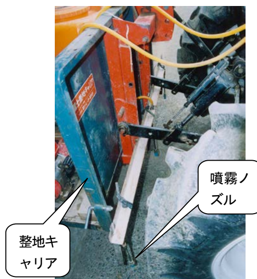
噴霧ノズルの取り付け状況
