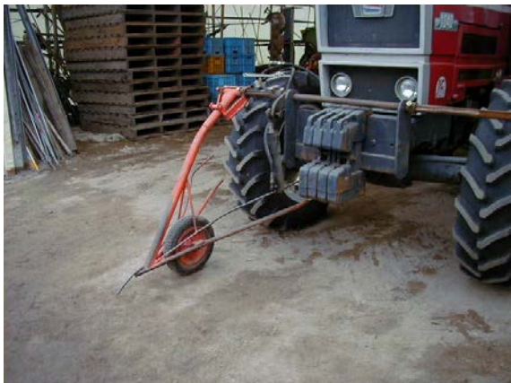
作目：共通 作業：栽培管理 目的：適正使用・管理 方法：走行時に作物を踏まないようにトラクタ前輪へ分草桿（デバイダ）を取り付け。
