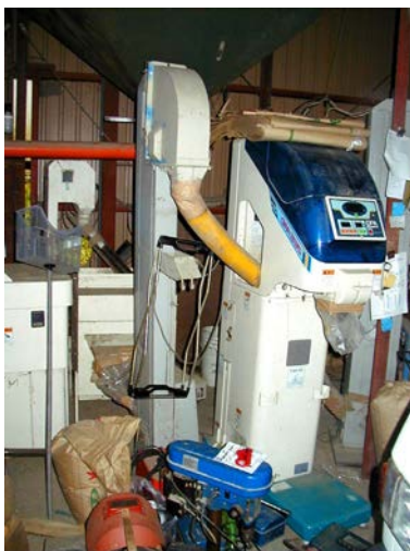
作目：水稻、穀物 作業：選別・調製、運搬 目的：重量物負担軽減 方法：粃摺り機と計量機のための受け継ぎ用に、バケットエレベータを製作。
