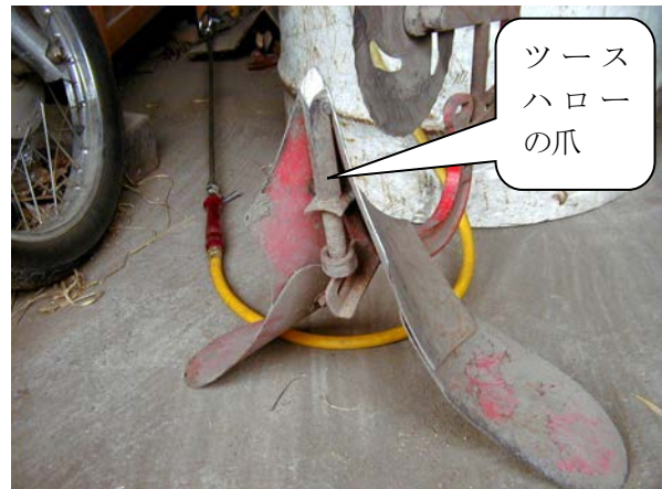
補強した培土板
