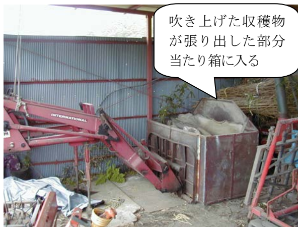
フロントローダーにバケットを装着した状態
