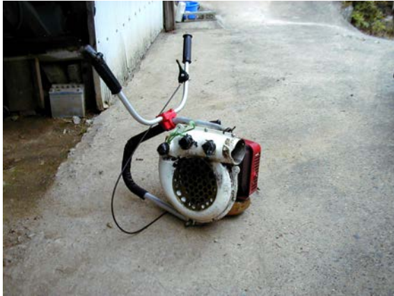
作目：茶 作業：収穫 目的：効率化・省力化 方法：茶樹の露を吹き飛ばす装置を製作。吸引口には網を取付け。
