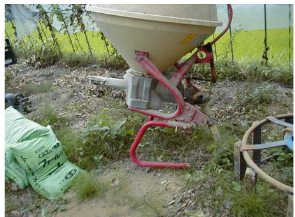
作目：共通 作業：機械使用・管理 目的：重量物負担軽減 方法：作業機のスタンドにキャスタを取付け。
