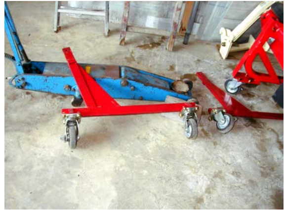
作目：共通 作業：機械使用・管理 目的：重量物負担軽減 方法：ロータリ用のスタンド（キャスタ付き）を製作。
