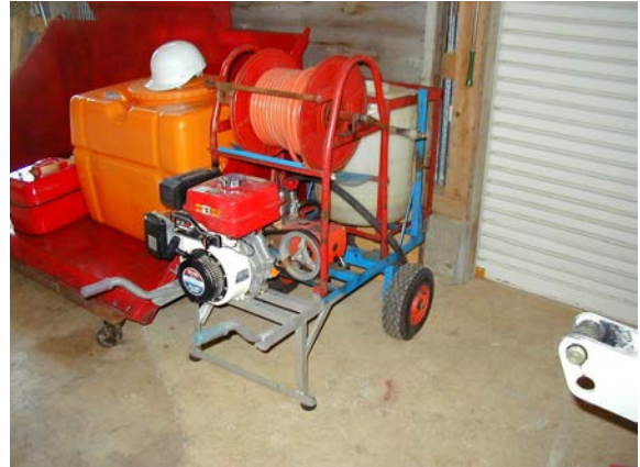
作目： 共通 作業： 防除、機械使用・管理 目的： 重量物負担軽減 方法： 動力噴霧機を運搬台車に載せ、保管、運搬。
