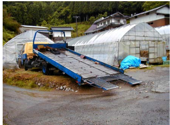
作目：共通 作業：機械使用・管理 目的：作業安全、効率化・省力化 方法：荷台がスライドするトラックに機械を載せ、圃場間を移動、運搬。
