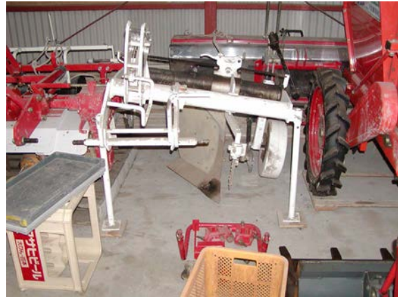
作目：共通 作業：機械使用・管理 目的：重量物負担軽減 方法：移動しやすいように作業機のスタンドの下へキャスタ付き台を入れた。
