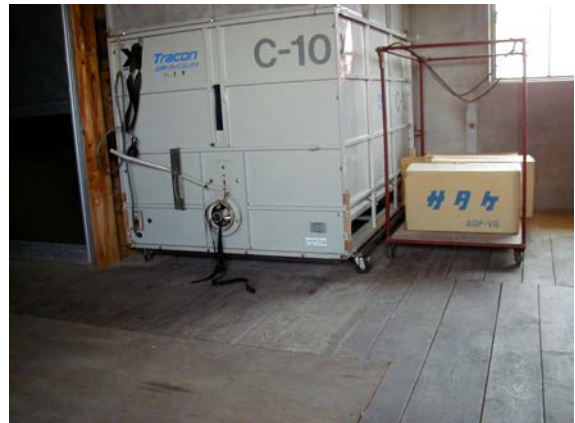
作目：共通 作業：機械使用・管理 目的：重量物負担軽減 方法：粃運搬用コンテナをキャスタ付き台に載せて、保管、運搬。
