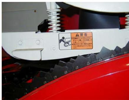
図2 自脱型コンバインの手こぎ部分付近の「警告」マーク
