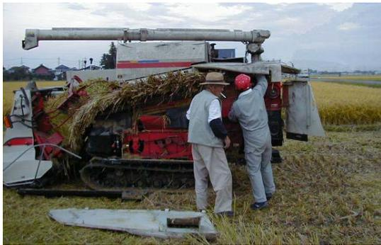
図1 自脱型コンバインの CUTターへ詰まったワラを取り除こうとしています。
