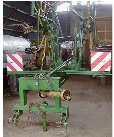
図 ロワーリンクでけん引する作業機
