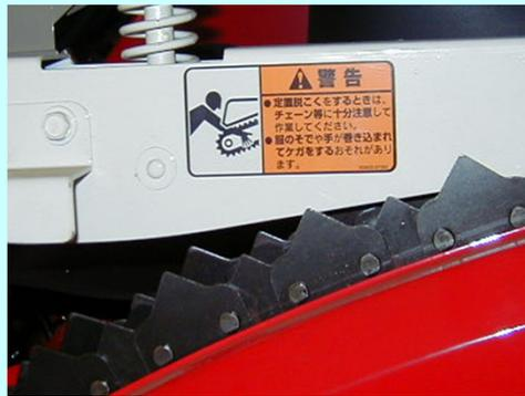
図2 自脱型コンバインの手こぎ部分付近の標識
