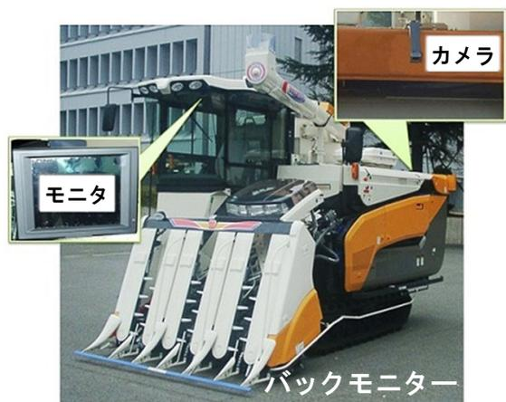
大型のコンバインでは、後進時の後方確認用のバックモニターが装備されている機種もあります。カメラの視野、距離感などを理解しながら安全性向上の補助手段として活用しましょう。
