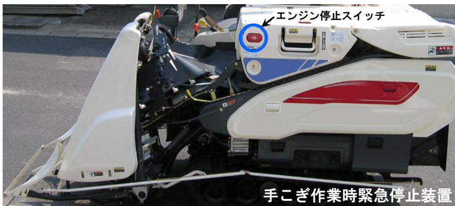
手こぎ作業時にエンジンを緊急停止させる装置の装備が安全要件として求められています。緊急時に作業者の身体や生命を守る装置ですので、作業前にその位置と作用を確認しておくことが大切です。
