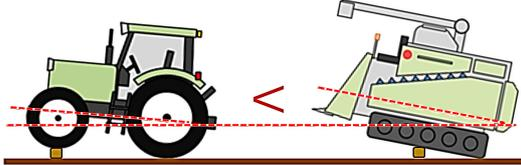
同じ凹凸でもコンバインの方が傾きが大きい
