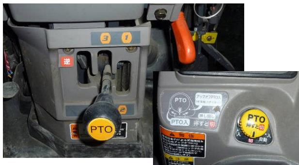
専用の PTO クラッチ (ボタン) がある場合は変速レバーと PTO クラッチの両方の確認が必要
