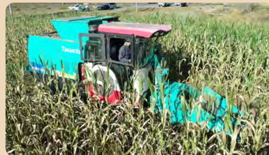
図7 イアコーン収穫スナッパヘッドを装着した収穫機
