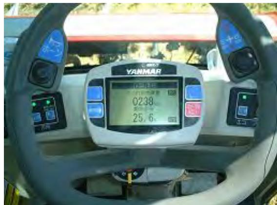
図5 液晶モニタ表示例
