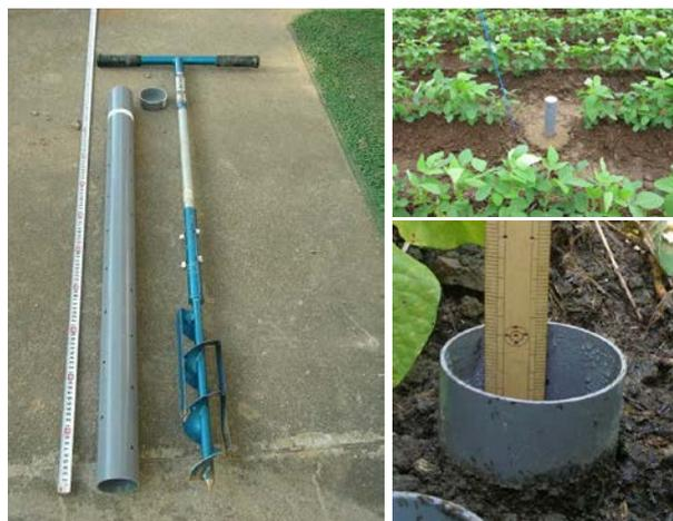
図5 ラセン式穴掘り機(改造)と塩ビ管(左)、ほ場での設置(右上)、地下水位測定の様子(右下)
