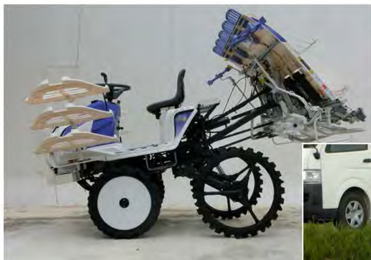
後輪昇降機構の作動状況 (前方に約9° 傾斜)
