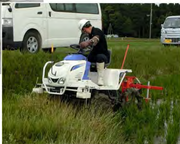
後輪昇降機構の作動状況 (前方に約9° 傾斜)
