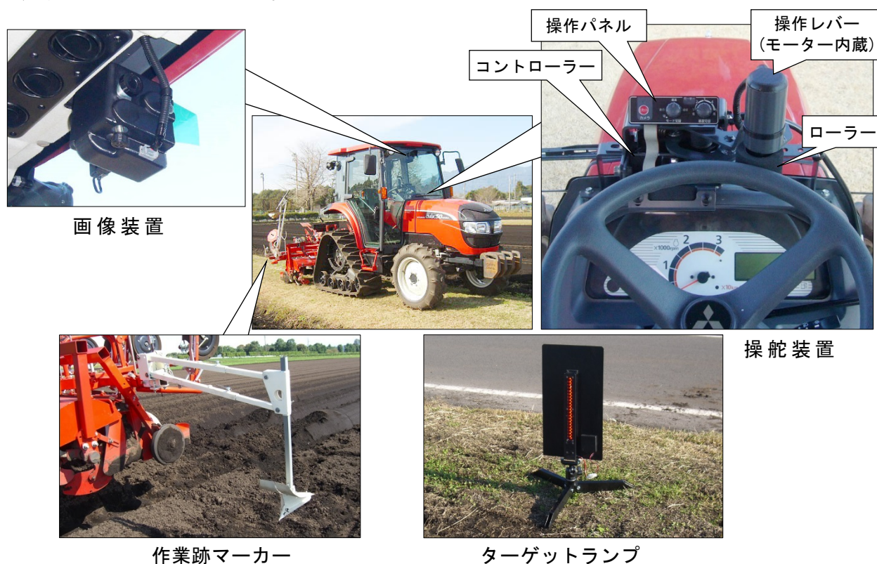
図1 直進作業アシスト装置の全体構成
