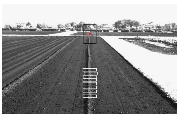
図8 直進アシスト機能用の画像処理の例
