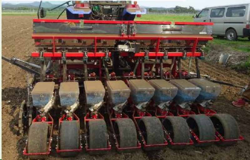
高精度高速汎用播種機 85馬力、5~10 km/h
