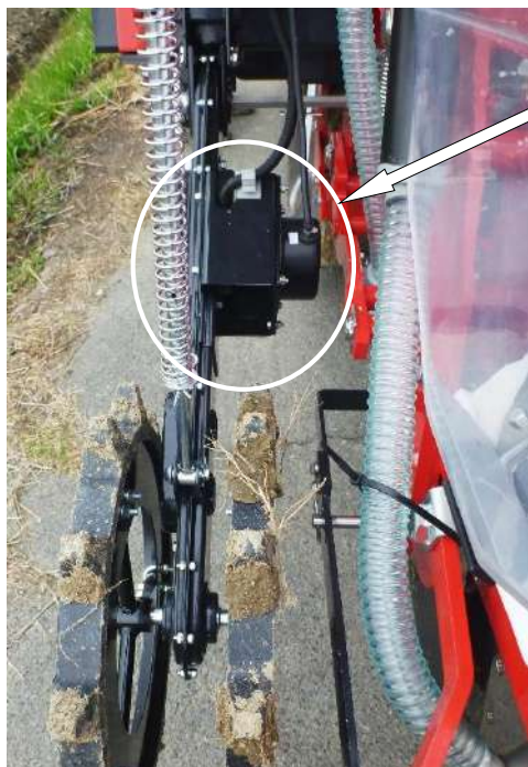
駆動輪にエンコーダを組み込み
