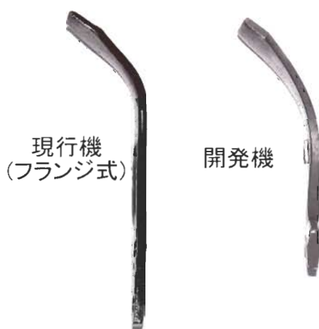
写真1 高速耕うんロータリー（右）と現行ロータリー（左）のロータリー爪
