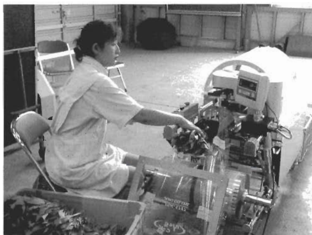
図 本機による計量・包装作業
