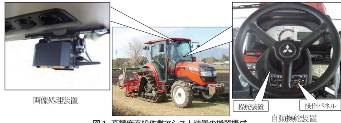
図1 高精度直線作業アシスト装置の機器構成
