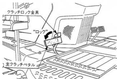
図22 主クラッチペダルのロック方法
