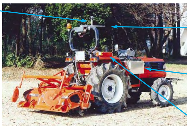
航法システム：光学測量方式（XNAV）
