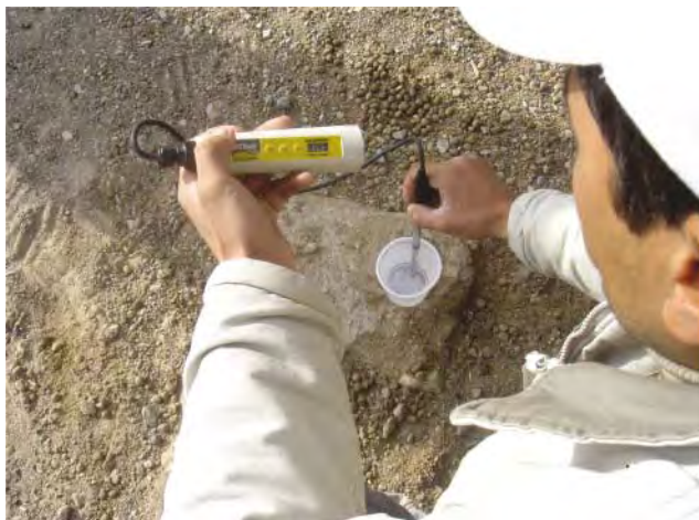
携帯式ECメータによる土壌塩分濃度の測定
