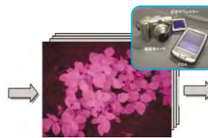
近赤外（830nm）画像を画像処理し、植被率を算出
