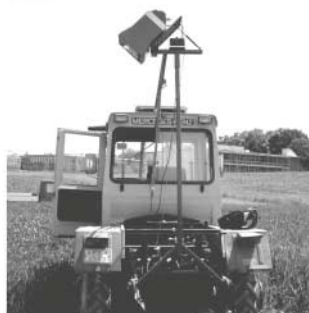
クロフィルの反射率測定による冬コムギとトウモロコシのSSCM
