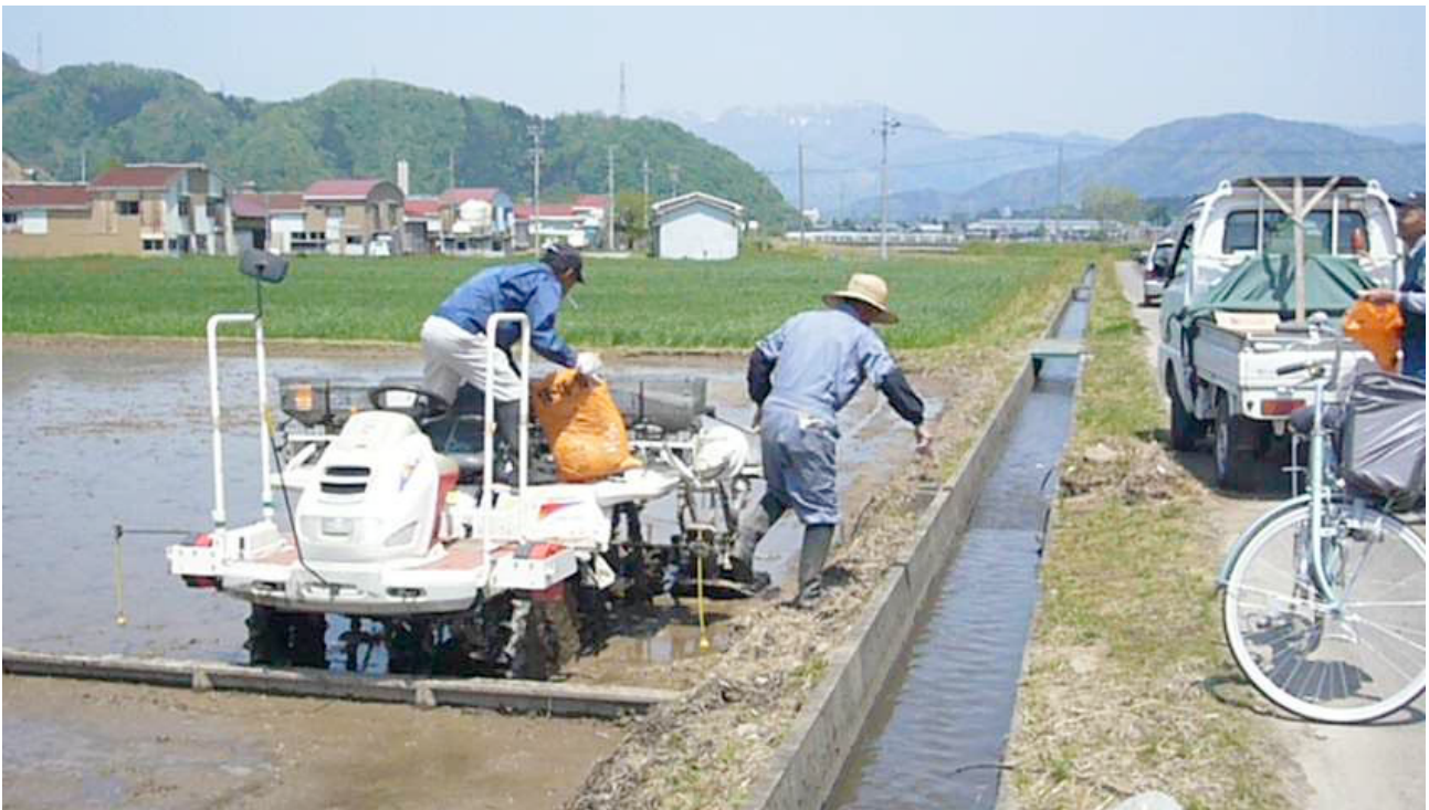
高精度水稻湛水直播機による作業（H21 年春 福井県大野市 生産組合提供）
