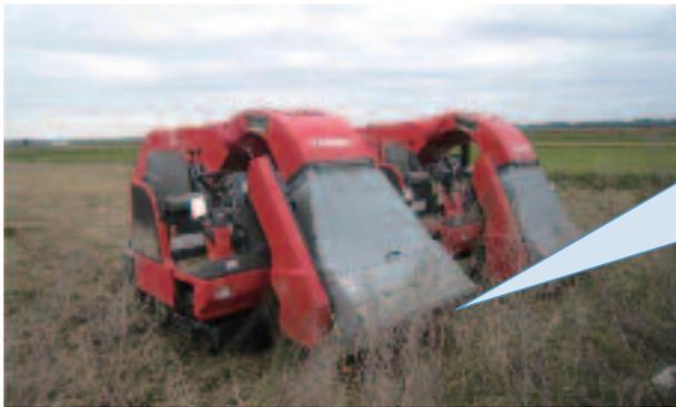
フレール型専用収穫機
