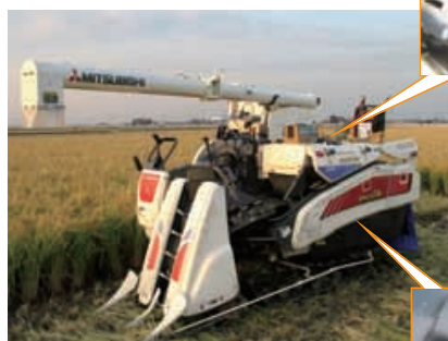
送塵弁制御+フッ化樹脂コート（210台）
