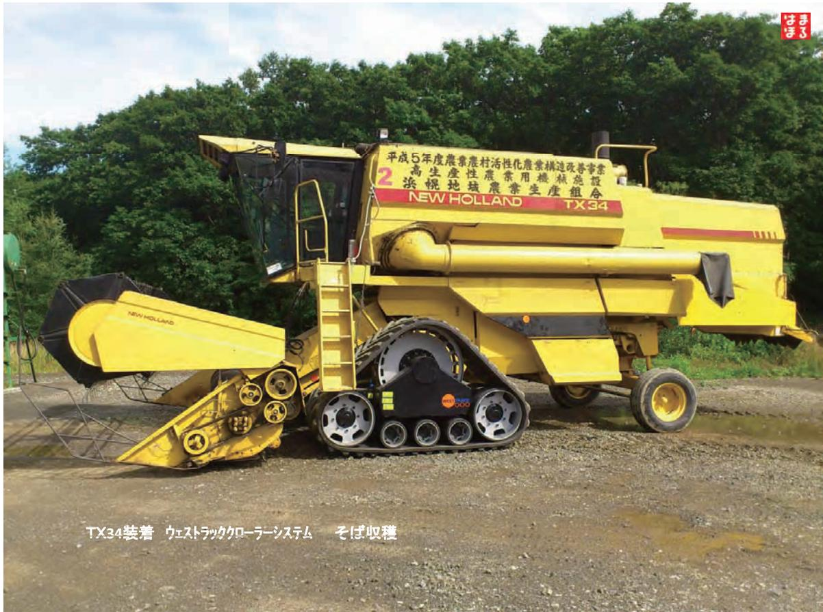
TX34装着 ウェストラックローラーシステム そば収穫
