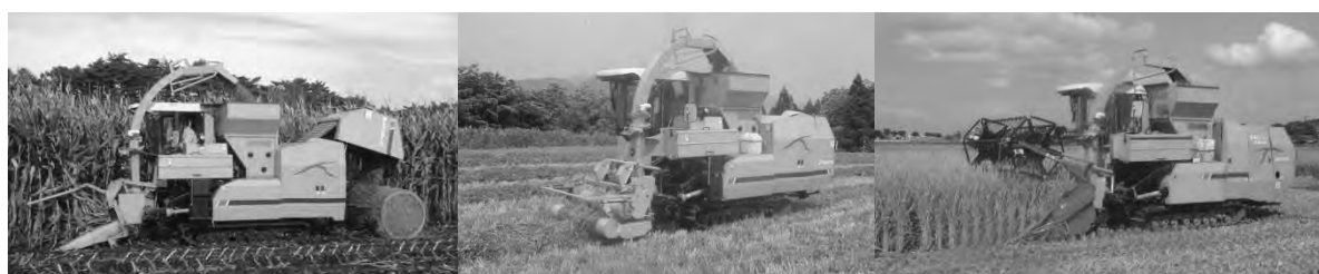
図2 開発機の作業風景 （左からトウモロコシ、予乾牧草、飼料イネの収穫作業）
