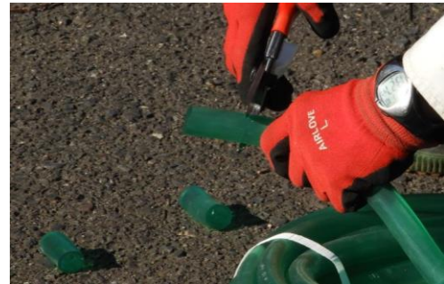
写真5 水道用ホースを果樹用剪定バサミで切る
