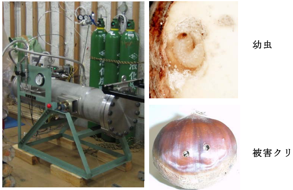
図1 大型高圧炭酸ガス処理装置（外径40cm・長さ155cm）とクリシギゾウムシ幼虫によるクリ被害
