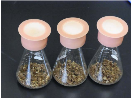
図5 小麦ふすま、コーンコブ、酸素漂白スギパルプ、硫酸から成る培地でのトリコデルマの固体培養によるセルラーゼのオンサイト生産
