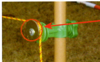
この部分が 通電する。
