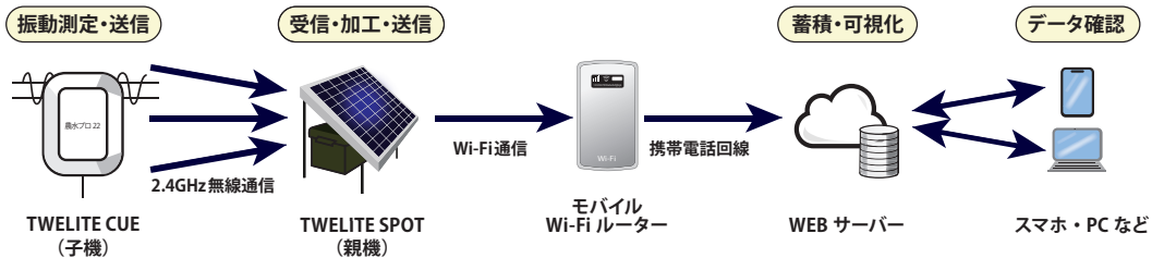
図1 振動測定からデータ確認までのシステム構成とデータ送信フロー
