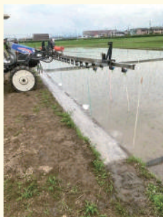
図2 移植直後の人工降雨による成分流出試験の様子と結果
