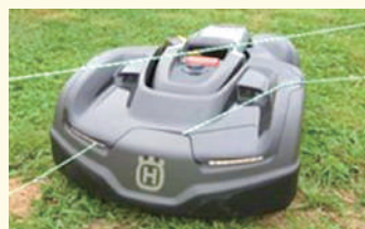
図1 除草ロボットのくぐり抜けによる柵線高への影響
