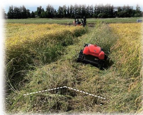
図3 既存のラジコン式草刈機を用いた除草試験
