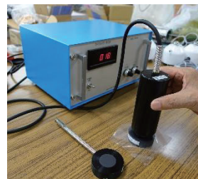
図2 放射率計を用いた被覆資材の長波放射特性測定
