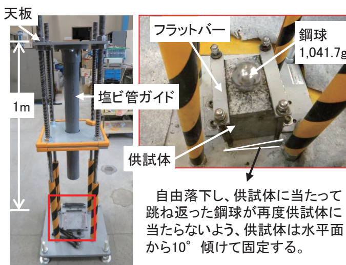
図2 鋼球落下式衝撃摩耗試験装置
