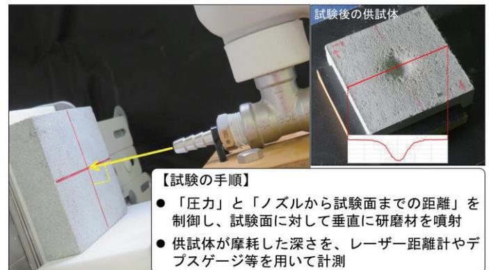
図2 試験の手順および供試体に生じる摩耗形態
