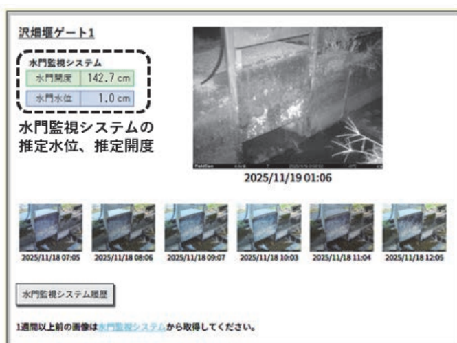
図2 外部のサービスを利用してカメラの画像や水門の開度、水位を表示した例
