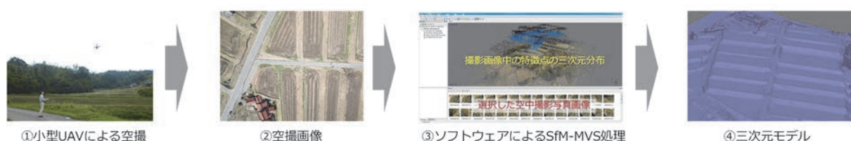
図1 小型UAV空撮から三次元モデル生成までの流れ
